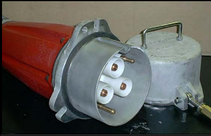
Acoplador Para Cable No Blindado, Macho 5kV, 400A se muestra con contactos banados en plata y cuerpo impermeabilizado (power coating), ambas características opcionales
